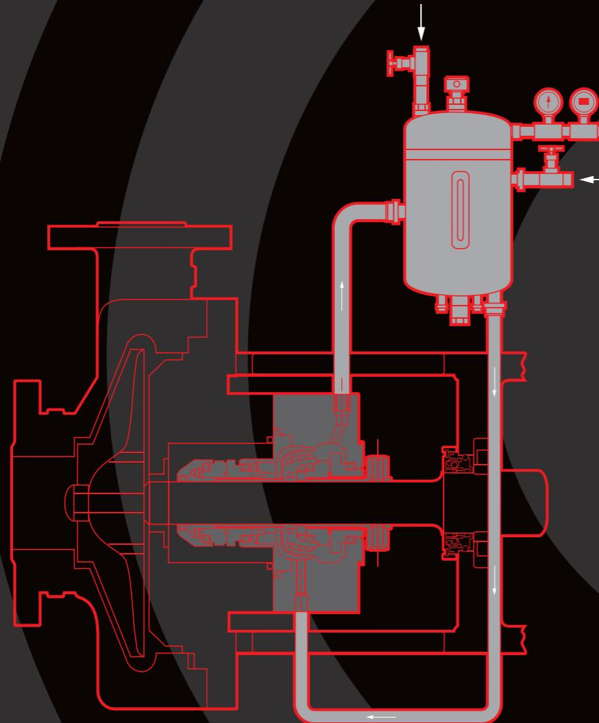
По **API плану 53А** реализуется циркуляция затворной жидкости под давлением между внутренней полостью уплотнения и внешним бачком системы обеспечения. В состоянии бездействия отвод тепла происходит за счет конвективного эффекта, а в рабочем состоянии за счет встроенного импеллера.
