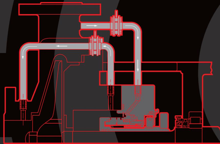
По API плану 14 реализуется циркуляция жидкости между линией нагнетания и линией всасывания через сальниковую камеру.
