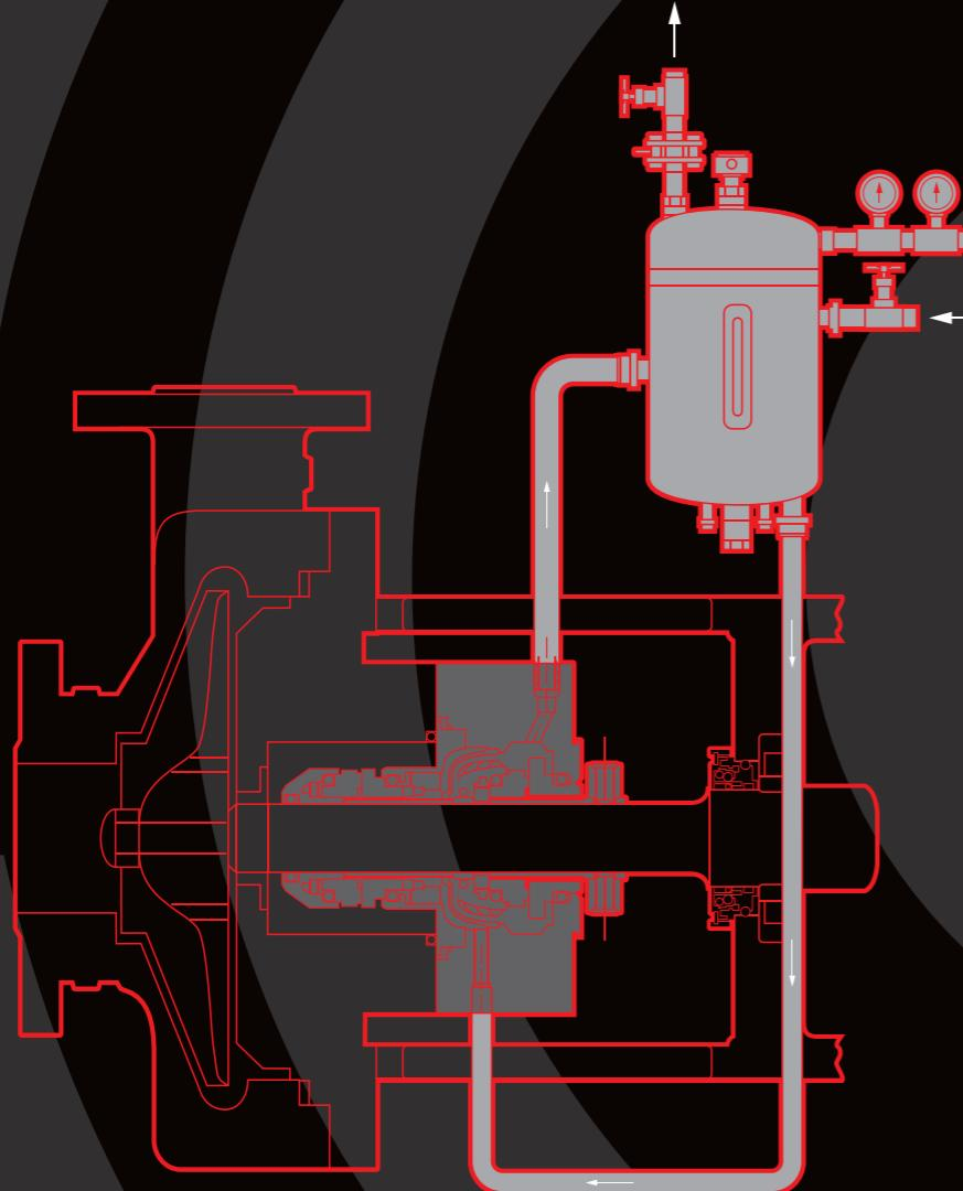
По API плану 52 реализуется циркуляция барьерной охлаждающей жидкости при давлении близком к атмосферному между внутренней полостью уплотнения и внешним бачком системы обеспечения. В состоянии бездействия отвод тепла происходит за счет конвективного эффекта, а в рабочем состоянии за счет встроенного импеллера.
