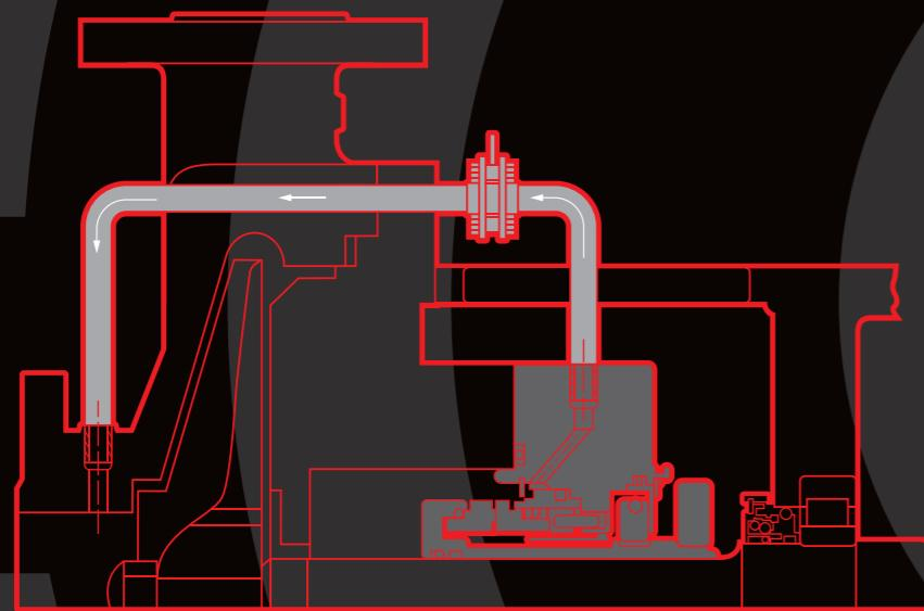
По плану API 13 реализуется циркуляция жидкости между линией всасывания и сальниковой камерой через фильтр грубой очистки.
