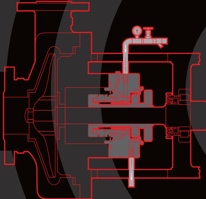
По API плану 62 реализуется непрерывная подача и слив охлаждающей жидкости в дренажную систему предприятия ([Quenchtodrain](#)).
