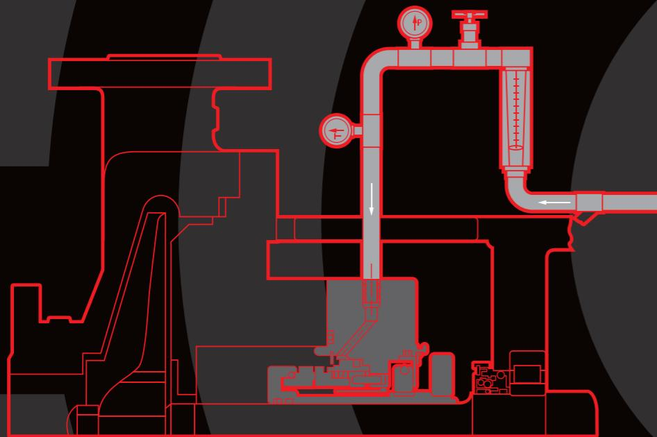
По API плану 32 реализуется подвод чистой промывочной жидкости в сальниковую камеру от внешнего источника.
