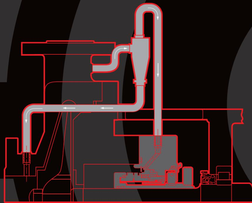
По API плану 31 реализуется циркуляция продукта между линией нагнетания и сальниковой камерой через сепаратор циклонного типа.
