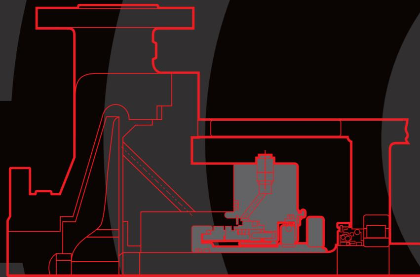
По API плану 01 реализуется внутренняя циркуляция жидкости между сальниковой камерой и линией нагнетания, через соединительный канал.
